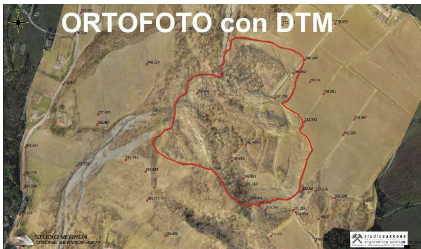
FIGURA 11. Vista da drone. Si noti il settore a meridione del perimetro rosso, interpretabile come area di progressa frana rimodellata, attualmente quiescente.
